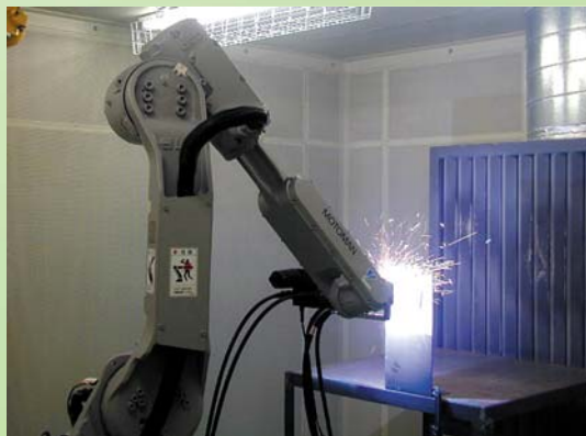
ロボットによるプラズマ溶射設備
